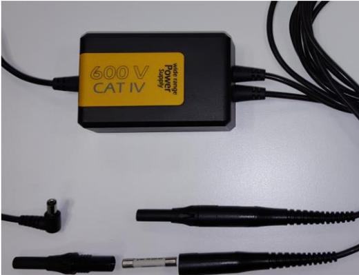
En el portafusibles solamente se deben utilizar fusibles de 6,3 mm x 32 mm, 3 A F, con una capacidad de desconexión de 50 kA. Solamente se deben utilizar fusibles con los datos idénticos.
