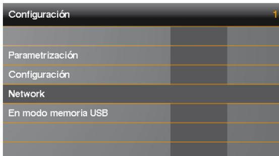
A través del modo de red se puede ajustar el WLAN o el LAN. Siempre puede estar activo solo uno de los dos modos de conexión.
